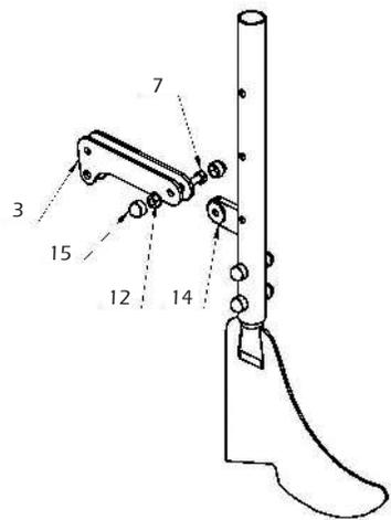
Serrer modérément la vis (7) pour que les pièces pivotent sans trop forcer. Les rondelles (14) limitent le frottement entre les pièces métalliques.
