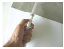
**Attention :** il est possible que de la poussière ou des billes de polystyrène du sac viennent bloquer le clapet de l'embout, cela se traduit par une perte de vide. Pour y remédier, il suffit d'utiliser de l'air comprimé et souffler un peu d'air jusqu'à ce que le clapet soit exempt de poussière.
