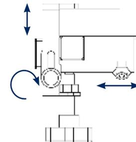
Réglage de la profondeur et de l'épaisseur du plateau
