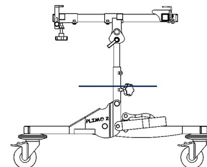
La hauteur du châssis peut être réduite en coupant le mat du pied et celui de la tête (la coupe doit être faite entre les 2 écrous)
