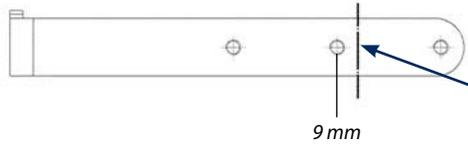
Pour adapter un socle d'une largeur comprise entre 320 mm et 420 mm, il vous faut recouper les glissières à 9 mm du milieu du trou central.
